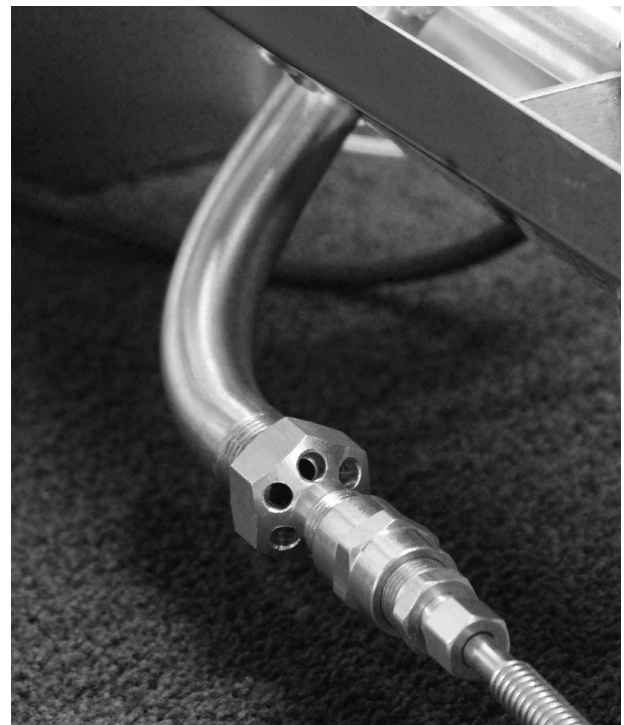
Figure 10 -Support d'injecteur sur le tube de brûleur à débouché
