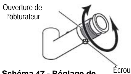
Schéma 47 - Réglage de l'obturateur d'air
