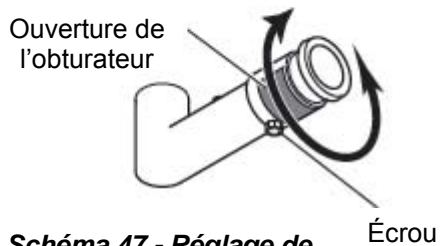
Schéma 47 - Réglage de l'obturateur d'air
