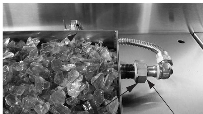
**Figure 10 - Support d'injecteur sur le tube de brûleur à débouché**
