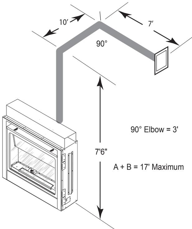
Schéma 21- Longueur maximale du conduit d'évacuation avec coudes
