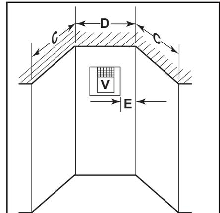
C = Maximum de profondeur est 48" (1219mm), pour emplacement en alcôve
