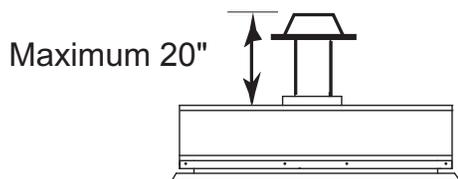
**Schéma 11 - Ventilation arrière, distance horizontale maximum**
