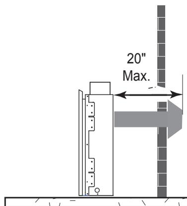
Schéma 19 – Conduit horizontal maximum sans élévation
