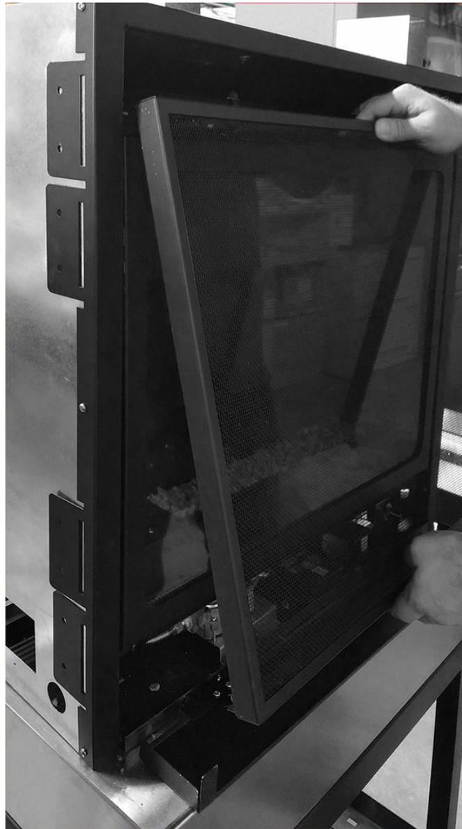
**ÉTAPE 1**: Alignez les trous sur deux pattes supérieures de l'écran de sécurité avec deux montants verticaux situés sur le dessus du foyer à côté de loquets de la porte de verre.
