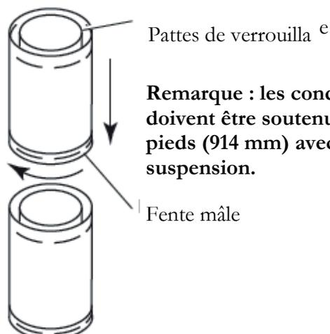
**Schéma 13 - Raccords de tuyaux d'évacuation rigides**
