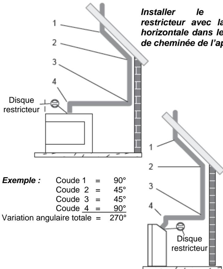
**Installer le disque restricteur avec la barre horizontale dans le collier de cheminée de l'appareil.**
