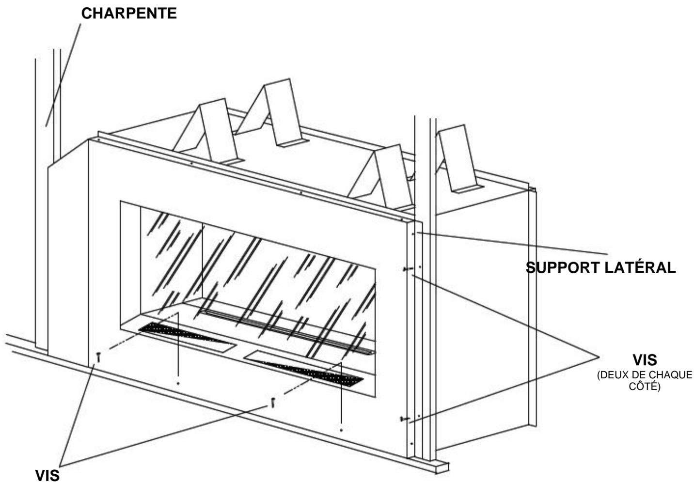
**Schéma 5 – Ancrage du foyer au plancher et aux montants de la charpente**
