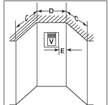
**C = Profondeur maximum de 48" (1219 mm) pour placement dans une alcôve**
