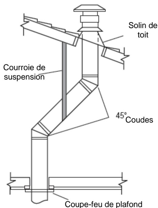
**Schéma 27 - Déviation avec courroie de suspension et coudes de 45°**
