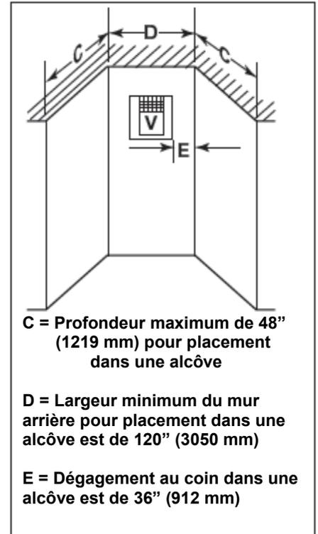
C = Profondeur maximum de 48" (1219 mm) pour placement dans une alcôve
