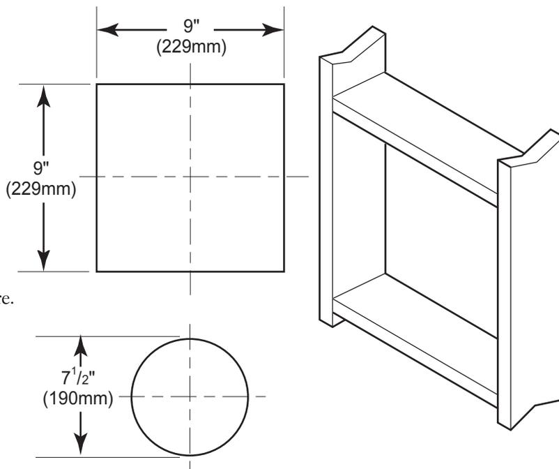
1. Déterminer et couper l'ouverture de l'évent sur le mur. Pour les murs combustibles encadrer d'abord l'ouverture. Voir Schéma 11.
