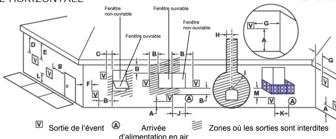
**Schéma 8 – Emplacements de sortie d'évacuation horizontale**
