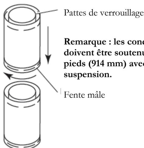
**Schéma 13 – Raccords de tuyaux d'évacuation rigides**
