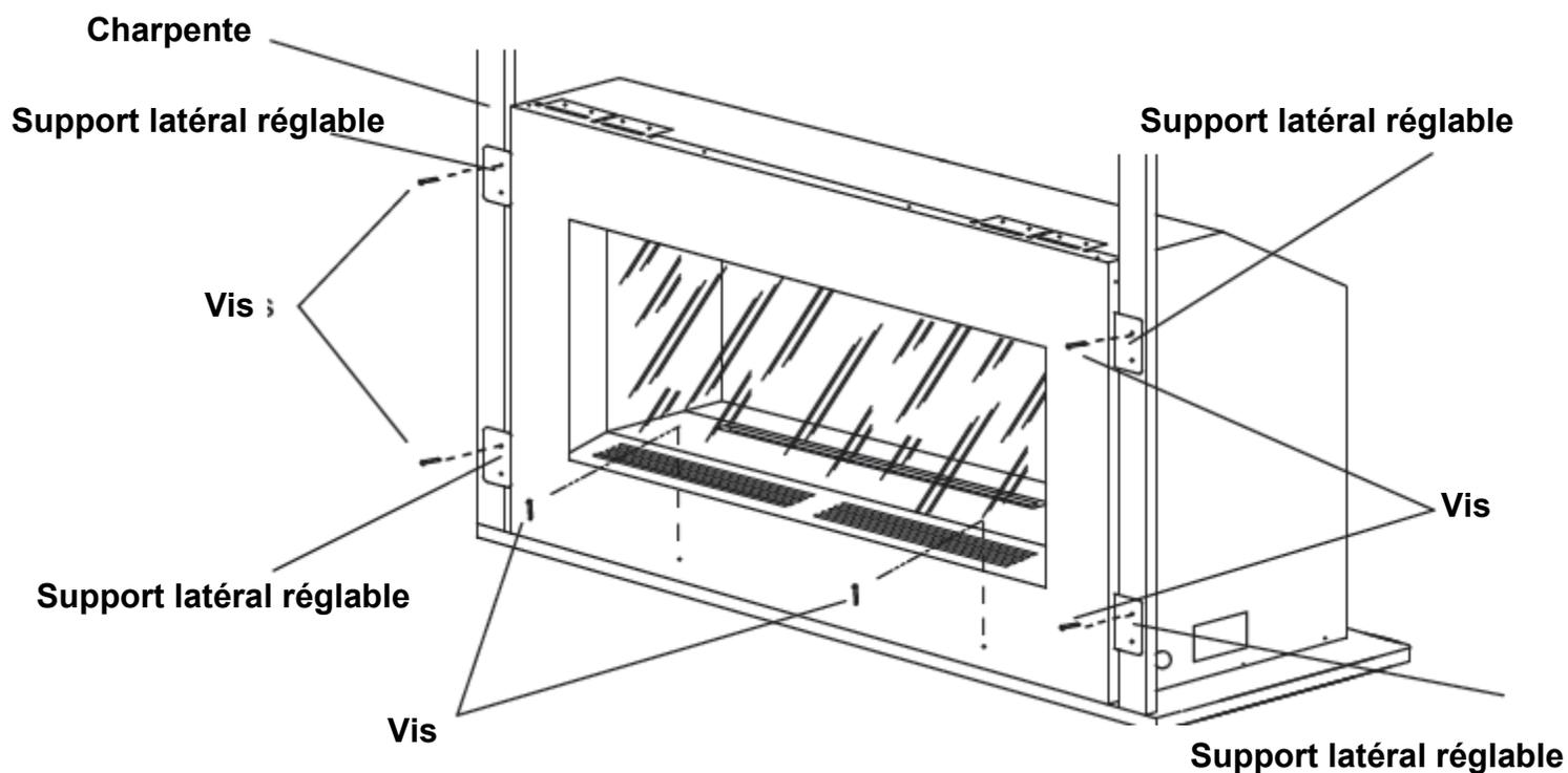
*Schéma 5 – Ancrage du foyer au plancher et à la charpente*
